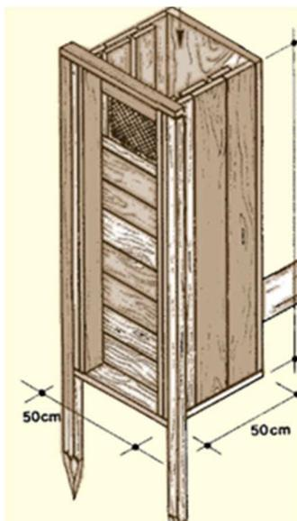
Le moine est **l'une des structures de drainage d'étang les plus anciennes et les plus courantes**. Il se compose d'une tour verticale fermée par des planches de bois pour réguler le niveau de l'eau. L'eau est évacuée par une canalisation enterrée sous la digue.
